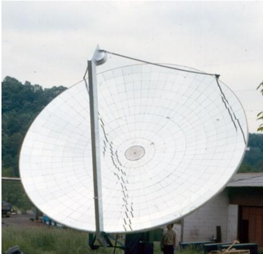
Εικόνα 1.3: Συγκεντρωτικός συλλέκτης παραβολικού δίσκου (parabolic dish) [12]
